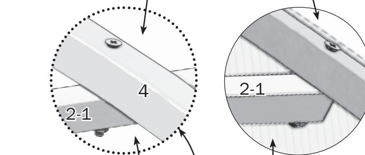
Используются уже установленные винты (этап 1). Снять гайки, установить прогоны 2-1 и закрутить гайки обратно.
