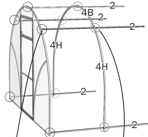
Используются уже установленные винты (этап 1). Снять гайки, установить прогон 2 и закрутить гайки обратно.
