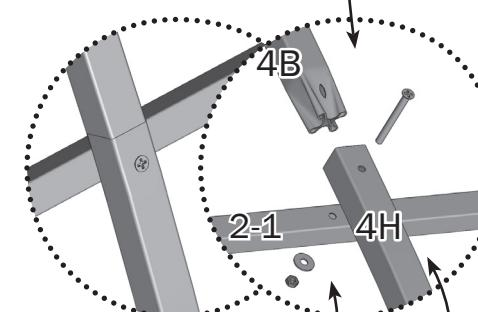
Используются уже установленные винты (этап 1). Снять гайки, установить прогоны 2-1 и закрутить гайки обратно.
