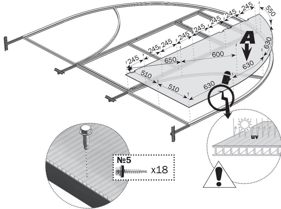
**!** Продольная жесткость теплицы обеспечивается верхними листами поликарбоната, а до его установки следует обеспечить устойчивость каркаса подручными средствами.
